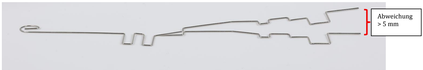
Abb. 14: Auf der exemplarischen Abbildung sind zwei Drähte zu sehen. Der untere Draht ist der optimal gebogene Draht und liegt flach auf der grauen Oberfläche auf.
